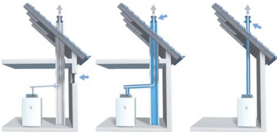
Rumluftafhængig opstillingsvariant med aftræksrør i skorsten
